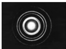
甲 电子束穿过铝箔后的衍射图样
