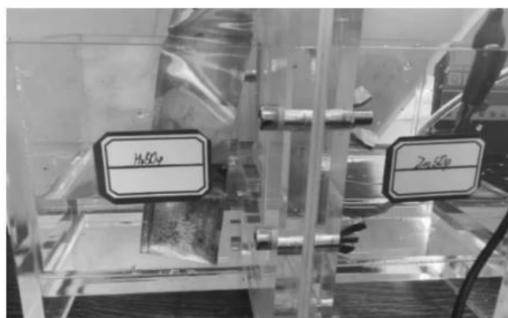
图6 锌铜隔膜原电池
