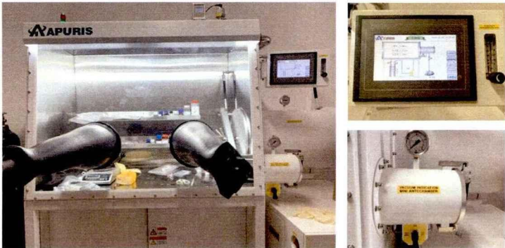
图 2.1 ICBS1200 型超级净化手套箱、西门子控制系统以及其过渡仓
