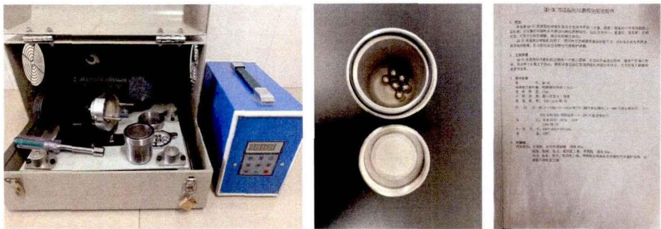
图 2.3 高温 QM-3C 型高速振动球磨机和球磨罐、钢球以及其说明书
