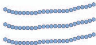
图4-4 纤维素的结构示意图（其中每个小的六边形代表一个葡萄糖的环状结构单元）
