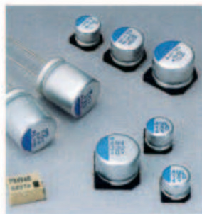
图2-9 使用了导电高分子材料的电子器件
