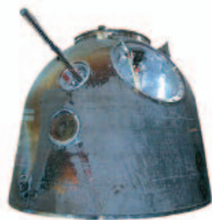
图5-5 宇宙飞船返回舱烧蚀后的外壳
