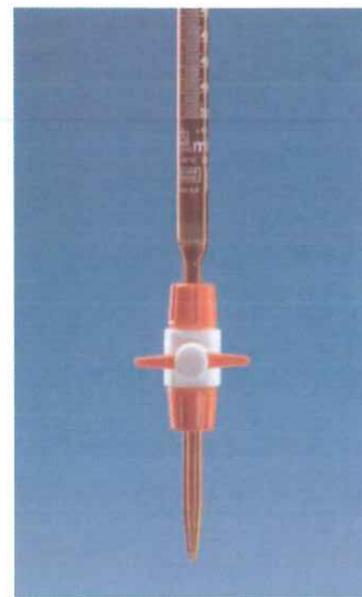
图 3-16 盛放见光易分解物质的棕色滴定管
