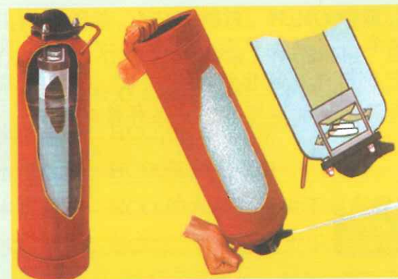
图 3-23 泡沫灭火器的原理和构造
