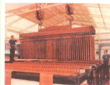
图 1-25 铜的电解精炼
