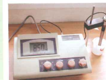
图 3-12 用pH计测量溶液的pH
