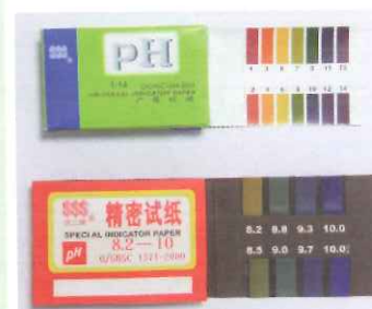
图 3-11 不同测量范围的pH试纸
