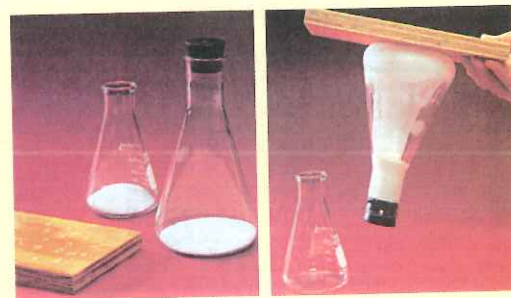
图 2-13 氯化铵晶体与氢氧化钡晶体的反应
