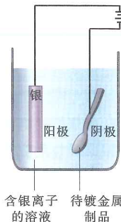
图 1-27 电镀银原理示意图
