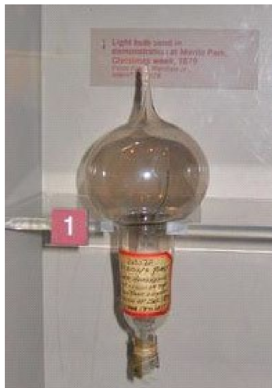
爱迪生发明的电灯灯泡 1879.10.21发明高阻力白炽灯 连续点燃了40个小时
