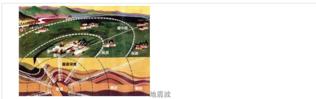
地震波按传播方式分为三种类型：纵波、横波和面波。纵波是推进波，地壳中传播速度为5.5~7千米/秒，最先到达震中，又称P波，它使地面发生上下振动，破坏性较弱。横波是剪切波：在地壳中的传播速度为3.2~4.0千米/秒，第二个到达震中，又称S波，它使地面发生前后、左右抖动，破坏性较强。面波又称L波，是由纵波与横波在地表相遇后激发产生的混合波。其波长长、振幅强，只能沿地表面传播，是造成建筑物强烈破坏的主要因素。
