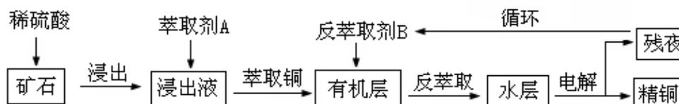
已知：①当矿石中三氧化二铁含量太低时，可用硫酸和硫酸铁的混合液浸出铜；②反萃取后的水层是硫酸铜溶液， $\text{Cu}^{2+}$ 浓度约为  $50\text{g/L}$ 。回答下列问题：
