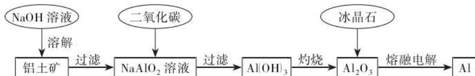
图1 “从铝土矿中提取金属铝”工业流程图
