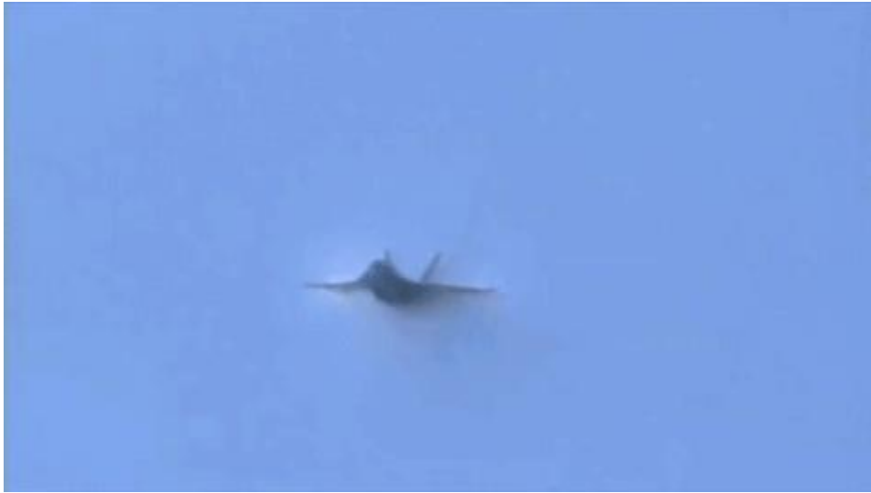
超音速飞机形成的普朗特-格劳厄脱凝结云
