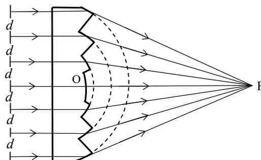
于不同球面的球台侧面, 其纵剖面如右图所示。这样的结构可以避免普通大口径球面透镜既厚又重的缺点。菲涅尔透镜的设计主要是确定每个环带的齿形(即它所属球面的球半径和球心), 各环带都是一个独立的(部分)球面透镜, 它们的焦距不同, 但必须保证具有共同的焦点(即图中 F 点)。已知透镜材料的折射率为  $n$ , 从透镜中心 O(球冠的顶点)到焦点 F 的距离(焦距)为  $f$ (平行于光轴的平行光都能经环带折射后会聚到 F 点), 相邻环带的间距为  $d$ ( $d$  很小, 可忽略同一带内的球面像差;  $d$  又不是非常小, 可忽略衍射效应)。求
