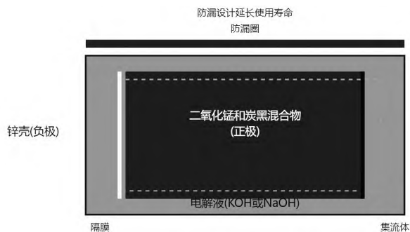
图2 5号电池内部结构示意图
