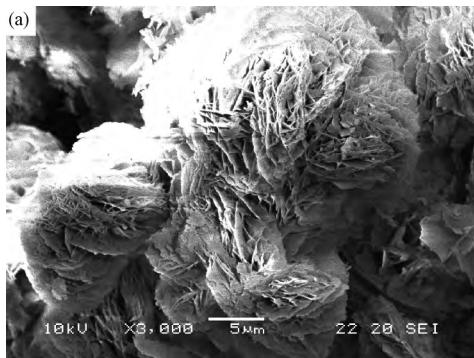
图 7 高纯碱式碳酸镁的 SEM 形貌(a)和 XRD 谱图(b)
